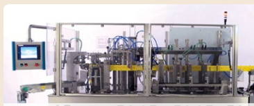
Автоматическая упаковочная рулонная машина для фасовки сыпучих и жидких продуктов в пакет дой-пак с ZIP-замком и угловым штуцером
